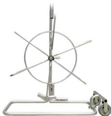
Aspo Ø 600 mm su telaio verticale, in acciaio zincato con anello guidasonda, impugnatura per il trasporto e sedi per l'alloggio degli accessori. Dotato di ruote. Può lavorare anche in appoggio orizzontale. Da utilizzare per sonde da 15 a 100 metri.
